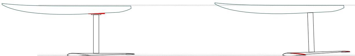
On peut mesurer cette valeur. Une méthode simple consiste à poser votre foil complet sur une table, de le caler de façon à ce que le bord d'attaque et le bord de fuite de l'aile avant soient à la même hauteur.
