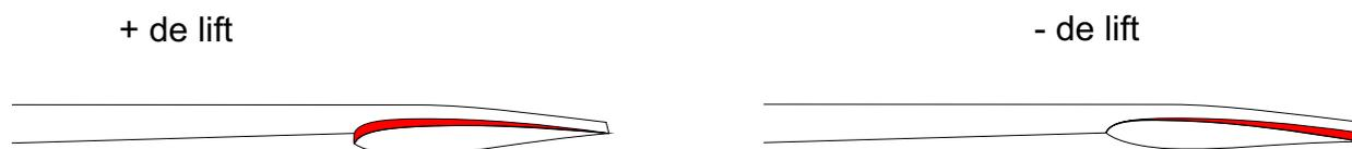
Il convient de bien identifier la vitesse de déplacement recherchée. Plus on va vite plus le stabilisateur prend de la pression et vous fera monter.
