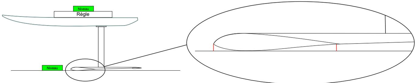
Le Rake influe aussi sur le départ. Nose Up, et votre foil sera orienté vers le bas au départ, et plaquera la board. Nose Down, et votre foil sera orienté vers le haut et vous freinera. L'idéal étant d'avoir un foil le plus à plat possible, de façon à prendre de la vitesse et laisser le profil décoller tout seul.
